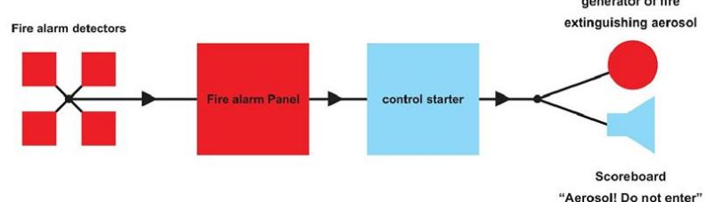
سامانه خاموش کننده آتش آبروسل H.E اولین خاموش کننده آبروسلی هیبریدی ساخته شده از مواد نانو آب گریز می باشد که پس از تشخیص حریق از طریق سنسور فعال شده و با انتشار گاز و ذرات خاموش کننده کوچکتر از 10 میکرون باعث اطفاء حریق می شود.
